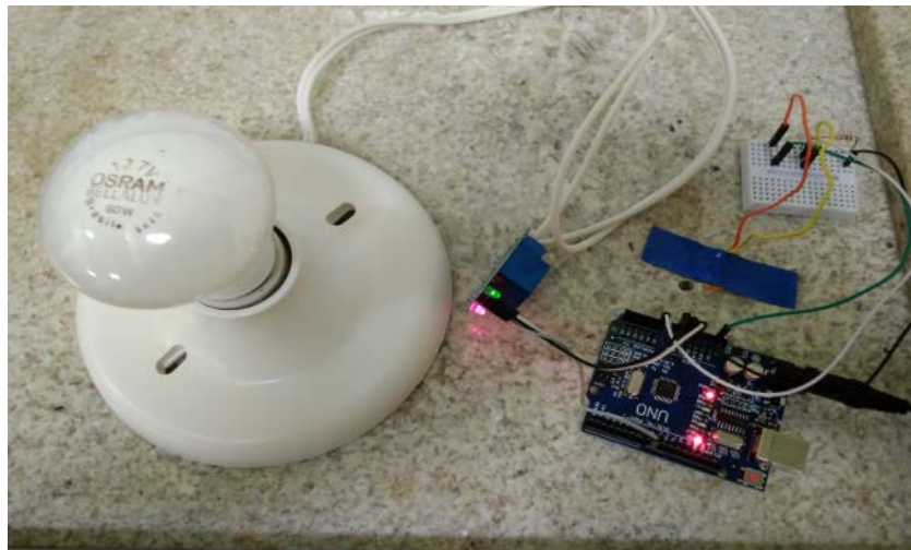
Figura 5 – protótipo de lâmpada inteligente construída.
