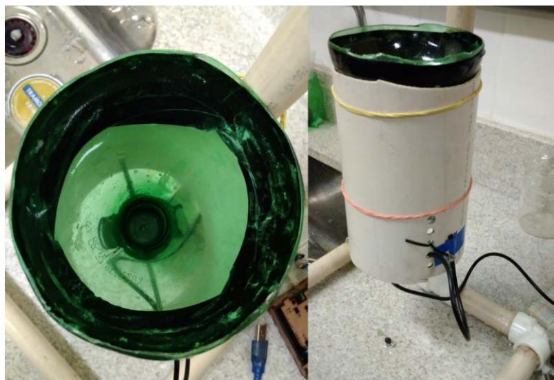
Figura 6 – protótipo do pluviômetro construído.
